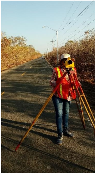
Se utilizó el nivel electrónico de alta precisión DINI
