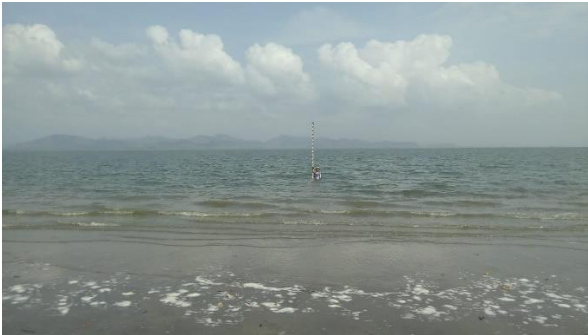
Nivelación Trigonométrica del nivel de la marea registrado diariamente a cada media hora desde el 19 al 28 de marzo, registrando información desde la estoa inferior hasta la superior o viceversa.
