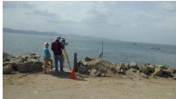
Nivelación Trigonométrica del nivel de la marea registrado diariamente a cada media hora desde el 19 al 28 de marzo, registrando información desde la estoa inferior hasta la superior o viceversa.
