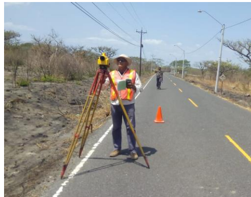
Se utilizó el nivel electrónico de alta precisión DINI
